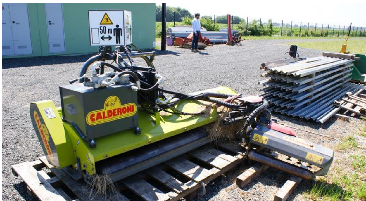
Zdjęcie nr 18. Farma fotowoltaiczna pod Parmą (Włochy), wykonana w identycznej technologii jak planowana instalacja. Dostawka do ciągnika rolniczego służąca do wykaszania terenu farmy
