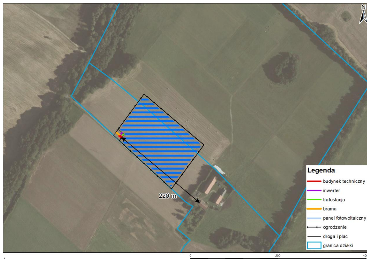
Mapa nr 10. Lokalizacja obiektów inwerterów oraz transformatora w stosunku do najbliższych obszarów chronionych akustycznie
